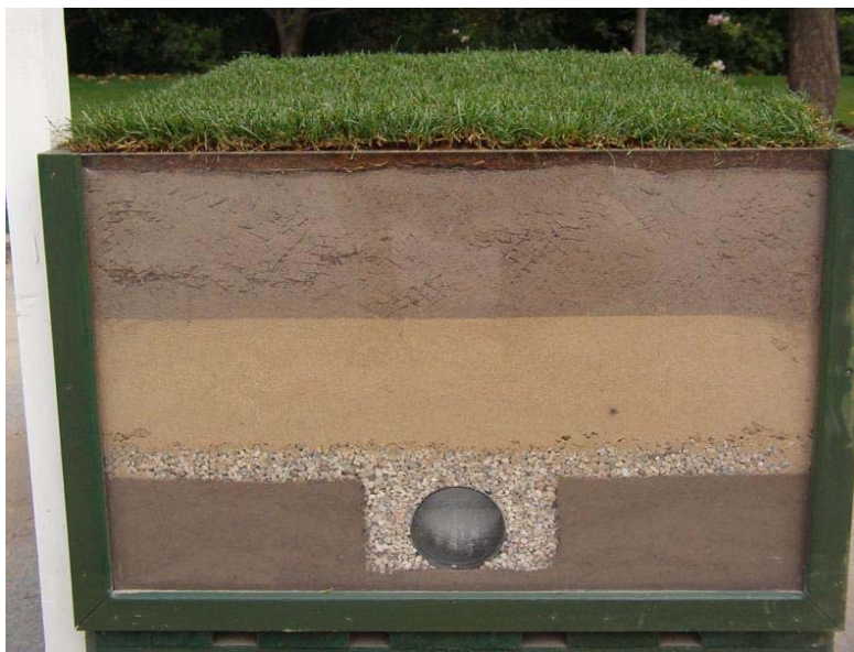
Abb.2: Typischer Aufbau einer Rasentragschicht mit darunterliegender Drainschicht und Drainage. (Bild: Martin Bocksch)
