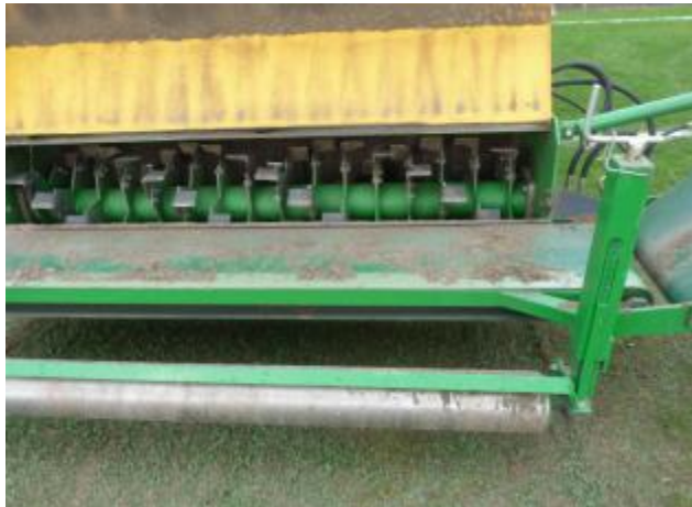
Abb. 4: Koro Field Topmaker mit Winkemessern.
