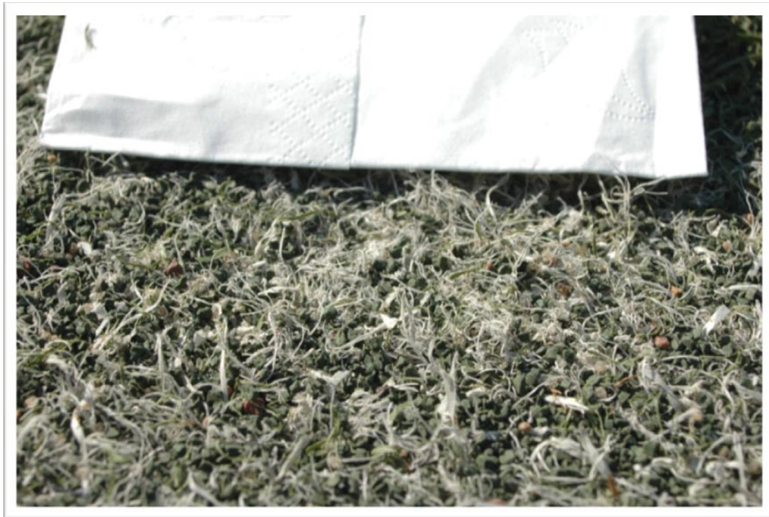
Abb. 2: Nahaufnahme der Fasern eines Kunstrasens, die sich in einem schlechten Zustand befinden (Foto: Jochen Watermann, 27.04.2007)
