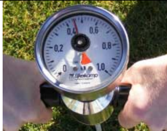
Abbildung 1: Messung des Eindringwiderstandes als Maß für die Bodenverdichtung mit einem Penetrometer
