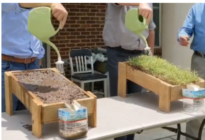
Abb.4: Demonstrationsversuch zur Erosion durch „Run-off“ bei Böden mit und ohne Rasenbewuchs. Virginia Department of Conservation and Recreation (DCR, 2023). https://www.linkedin.com/company/virginia-dcr/posts/?feedView=all
