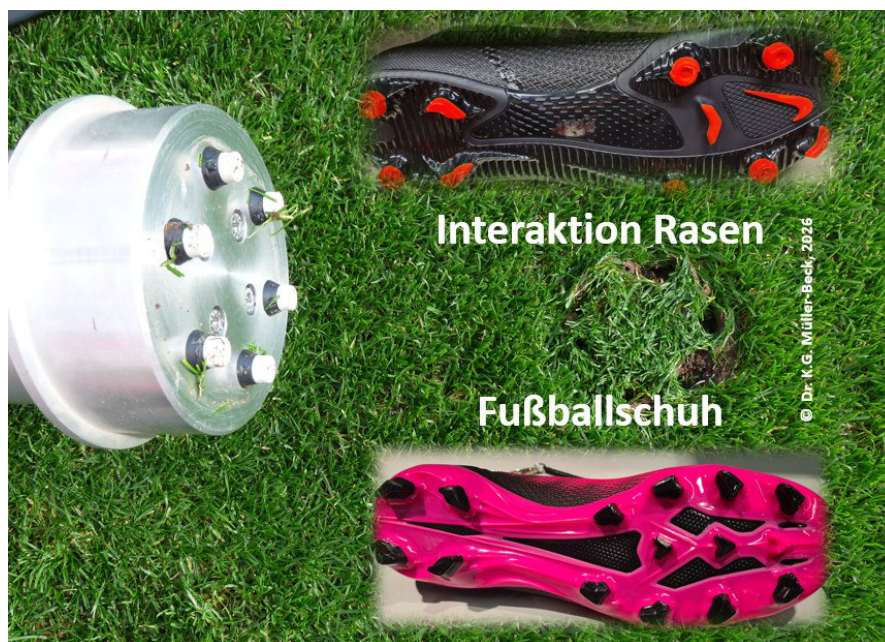
Abb.3: Die Standsicherheit der Spieler wird bei den üblichen Bewegungsabläufen, wie Drehung, Grätschen, Stoppen, Springen etc. durch die Interaktion zwischen Fußballschuh und Rasennarbe definiert.
