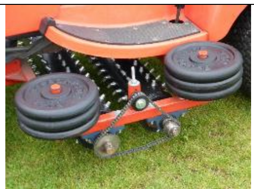
Abb.3: Doppelstollenwalze im Unterbau am Rasenmäher, mit Schlupfantrieb. Foto: ILOS
