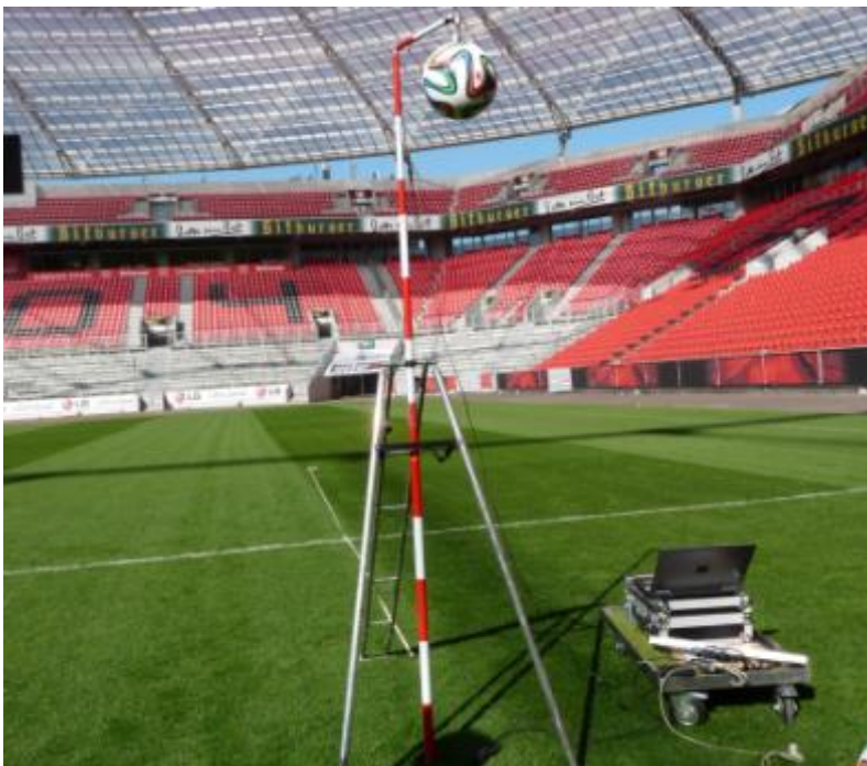
Abb. 1: Messung des Ballrücksprungsverhaltens (Ball-Rebound) bei Stadionrasen. Foto: K.G. Müller-Beck
