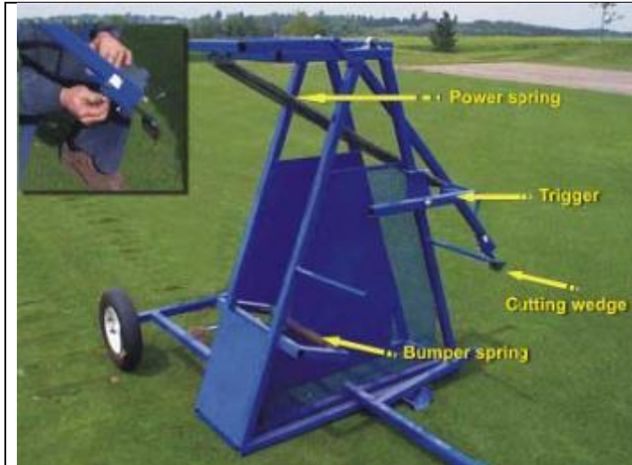
Abb.2.:Konstruktion eines „Divot Makers“ mit einem justierbaren Wege zur Einstellung der Tiefe beim Ausschlagen von Divots auf Versuchspartellen eines Golfrasens. (Foto: CAREY und GUNN, 2000)
