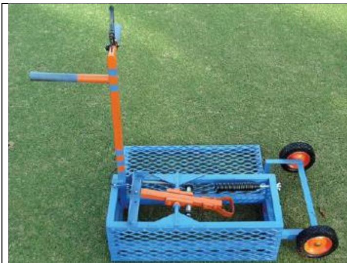
Abb.3: Sonderanfertigung eines „Divot-Makers“ an der University of Florida zur Erzeugung gleichmäßiger Divots auf Rasenversuchspartellen. (Foto: BRADLEY et al. 2010)
