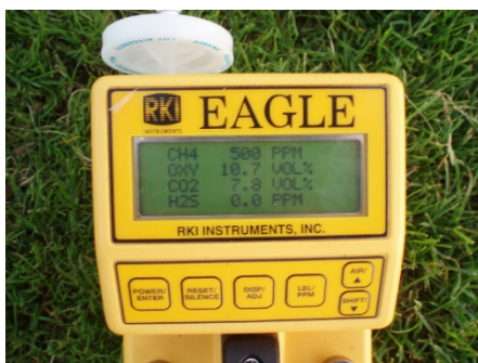
Foto 4: Zusammensetzung der Bodenluft in verdichtetem Boden: < 10 % O 2 , > 5 % CO 2 , Nachweis von Methan (CH 4 ) und/oder Schwefelwasserstoff (H 2 S). Foto: H. Nonn
