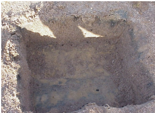
Foto 2: Marmorierung am Boden der Schürfgrube und black layer (rechter, oberer Rand der Schürfgrube). Häufig zu beobachtendes Erscheinungsbild bei Bodenverdichtungen. Deutlich sichtbarer Wechsel zwischen sauerstoffreichen (braunen) und sauerstoffarmen (grauen) Zonen. Foto: H. Nonn
