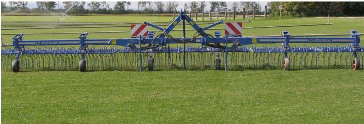
Abb. 4: Rasenstriegel mit Federzinken zur Entfernung von abgestorbenen Pflanzenteilen. Foto: K.G. Müller-Beck
